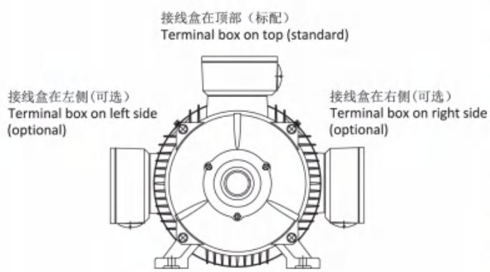
JPM 系列电机主接线盒在轴伸端顶部（标准位置），也可以处于机座的左侧或右侧。
