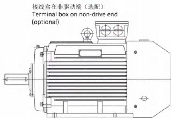
接线盒是可以 90 度旋转的，这样可以方便调整进线孔的方向指向左、右、驱动端或非驱动端。
